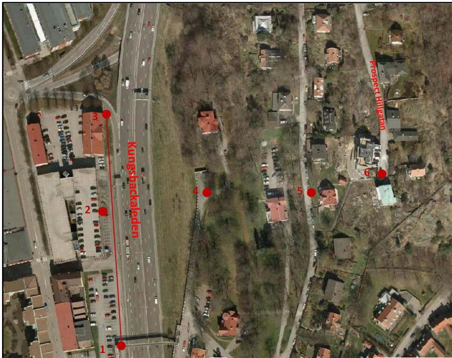
Figur 2. Diffusionsprovtagarnas placering längs mätsträckan i Gårda och de tre mätpunkterna öster om Kungsbackaleden. Källa: Infovisaren © Lantmäteriet
