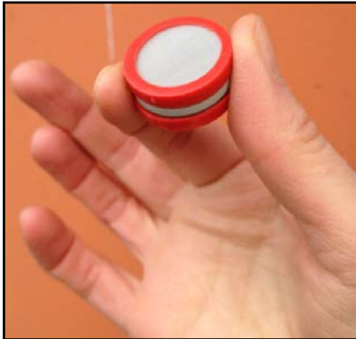
Figur 1. Diffusionsprovtagare för kvävedioxid.
